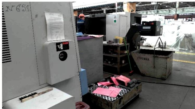
При картировании процесса производства выявлена проблема отсутствия мест временного хранения заготовок перед токарной, фрезерной операцией. Тара занимает 80% полезной площади вокруг станков с ЧПУ.
